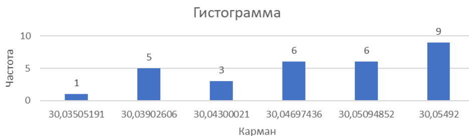
Рис. 4. Действительное распределение размеров вала в соответствии с равномерным законом распределения
